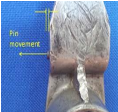
Figur 2 - Skadet benstopper med pinnen ute av posisjon
